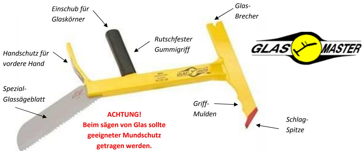
Der Glasmaster ist bei uns insgesamt 3-mal vorhanden, wobei sich die 3 Typen untereinander leicht in Form und Handhabung unterscheiden. Die oben beschriebenen Grundfunktionen sind jedoch bei allen 3 Modellen gleich. Grundlegendste Unterschiede der einzelnen Modelle sind: fehlender Glasbrecher Ausschnitts (TLF- Glasmaster), Eingeklappte Säge (LF Wandhalter – Glasmaster).
